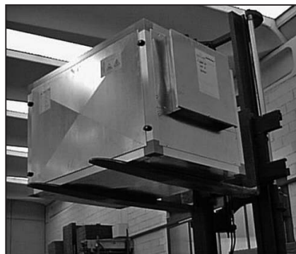
Figura 2 – Movimentazione non corretta del carico
