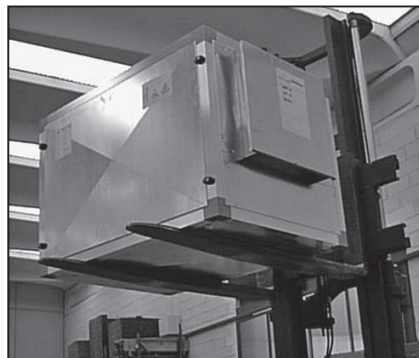
Figura 2 - Movimentazione non corretta del carico
