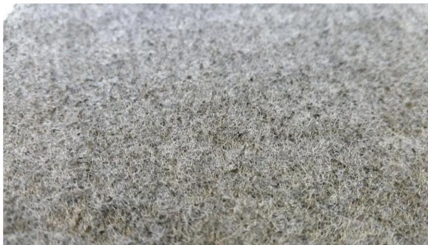
*Setto in poliestere impregnato di polvere di carbone attivo*
